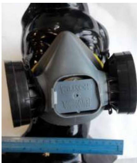
Рис. 3. Процедура визначення проектної площі обтюратора респіратора (а), одягненого на манекен голови з нанесеним м'яким покриттям (б)
