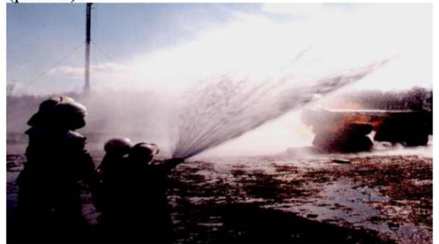
Рис. 7. Фото экспериментов с опытным образцом насадка ствола-распылителя
