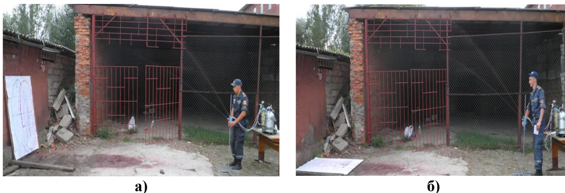
Рис. 1. Примеры испытаний: а) подача ОС навесным потоком двумя стволами-распылителями на горизонтально расположенную мишень-экран; б) тоже, – двумя стволами-распылителями на вертикальную мишень-экран: первый – красный; второй – синий
