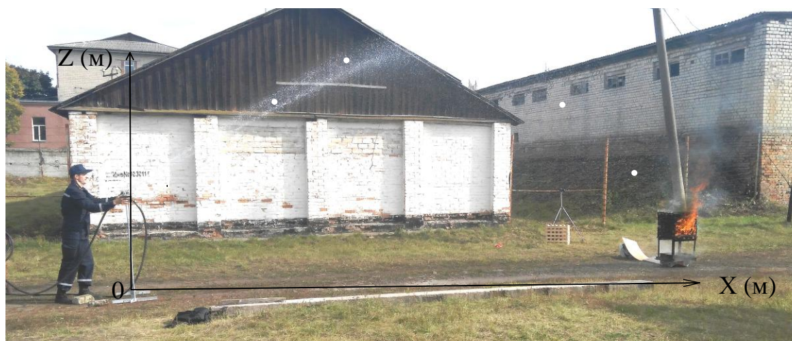
Рис. 2. Формування експериментальних даних для аналітичної побудови траєкторій руху струменів, що подаються з установки АУГГУС-М
