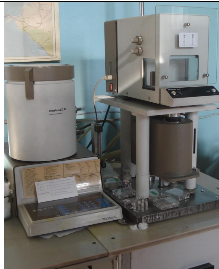
Рисунок 2.14. Термоаналитическая система “Mettler TA 3000” а – внешний вид установки, б -- – рабочий стол установки;
