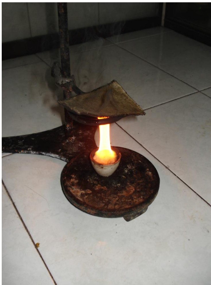
Рисунок 3.1. Установка для изучения огнезащитных свойств ГОС на образцы брезента при действии пламени напалма
