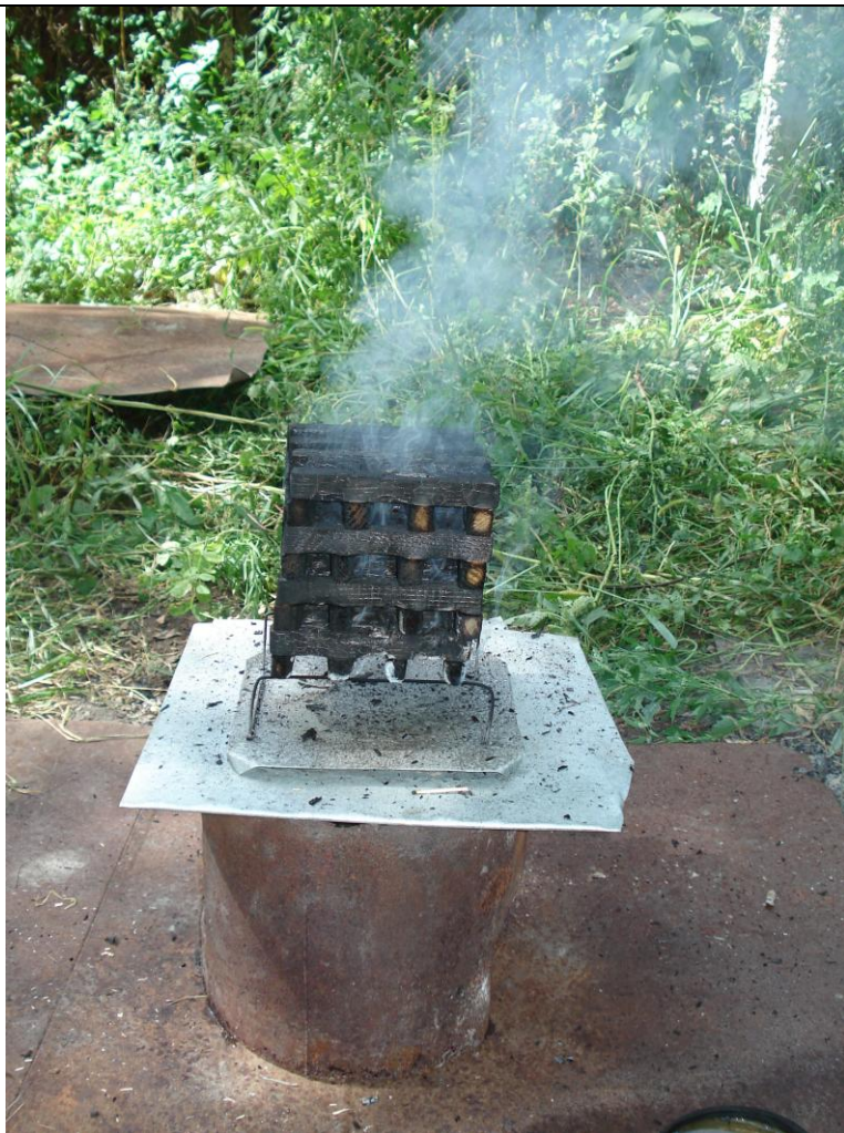
Рис. 3.8. в – модельный очаг, потушенный ГОС (\text{NH}_4)_2\text{SO}_4 + \text{NH}_4\text{H}_2\text{PO}_4 + \text{Na}_2\text{O} \cdot 2,7 \text{SiO}_2 ; г – модельный очаг, потушенный ГОС \text{CaCl}_2 + \text{Na}_2\text{O} \cdot 2,7 \text{SiO}_2 .
