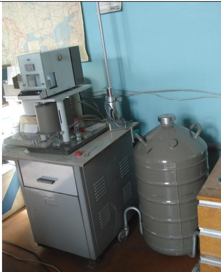
Рисунок 2.14. Термоаналитическая система “Mettler TA 3000” а – внешний вид установки, б -- – рабочий стол установки;
