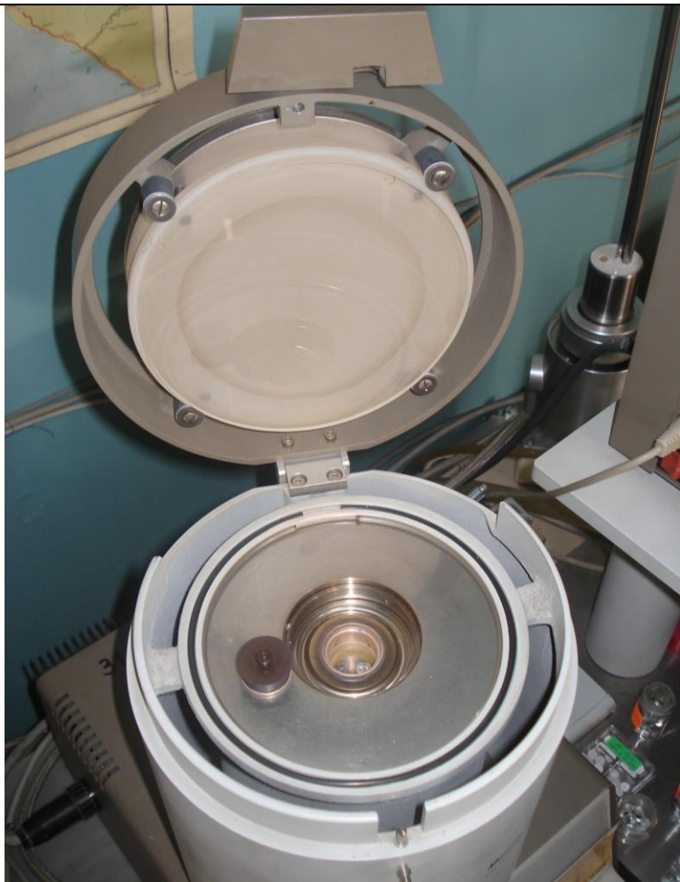
Рисунок 2.14. Термоаналитическая система “Mettler TA 3000” в – ДСК–ячейка, г – микротигли. вид установки; б – рабочий стол; в – ДСК–ячейка, г – микротигли.
