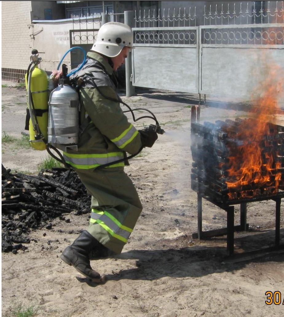
Рисунок 5.3. в – тушение стандартного модельного очага 1А, б – потушенный модельный очаг.
