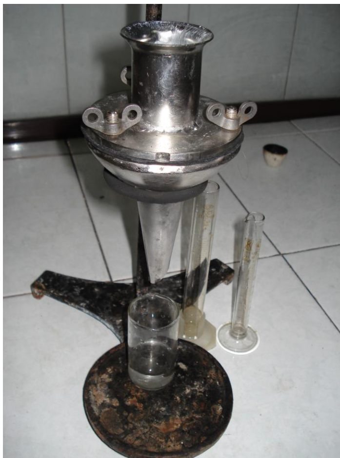
Рисунок 2.10. Внешний вид установки для определения смачивающей способности ГОС.
