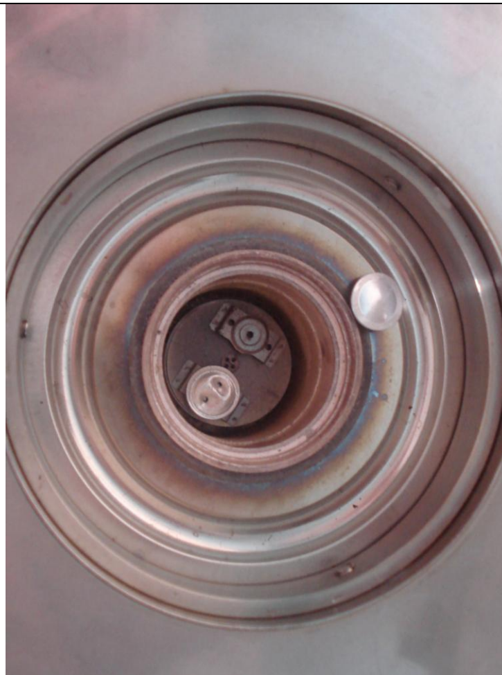
Рисунок 2.14. Термоаналитическая система “Mettler TA 3000” в – ДСК–ячейка, г – микротигли. вид установки; б – рабочий стол; в – ДСК–ячейка, г – микротигли.
