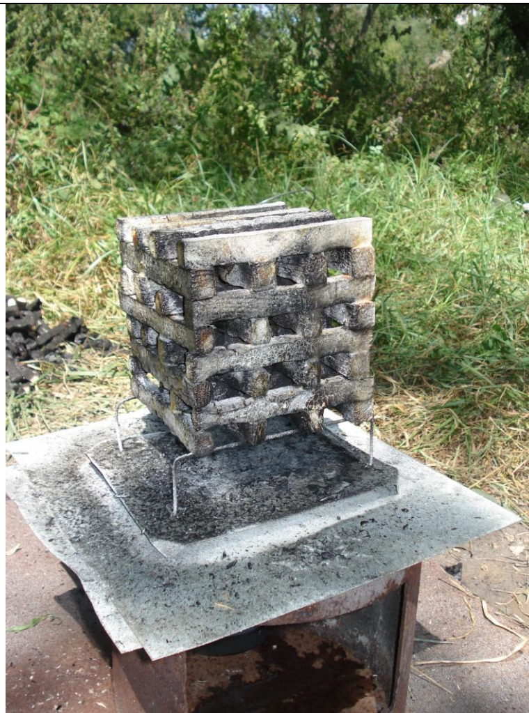
Рис. 3.8. в – модельный очаг, потушенный ГОС (\text{NH}_4)_2\text{SO}_4 + \text{NH}_4\text{H}_2\text{PO}_4 + \text{Na}_2\text{O} \cdot 2,7 \text{SiO}_2 ; г – модельный очаг, потушенный ГОС \text{CaCl}_2 + \text{Na}_2\text{O} \cdot 2,7 \text{SiO}_2 .
