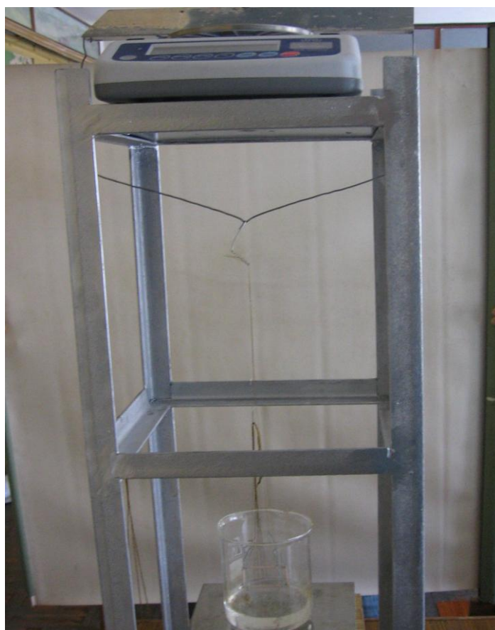
Рисунок 2.8. Установка для определения поверхностного натяжения методом отрыва кольца.
