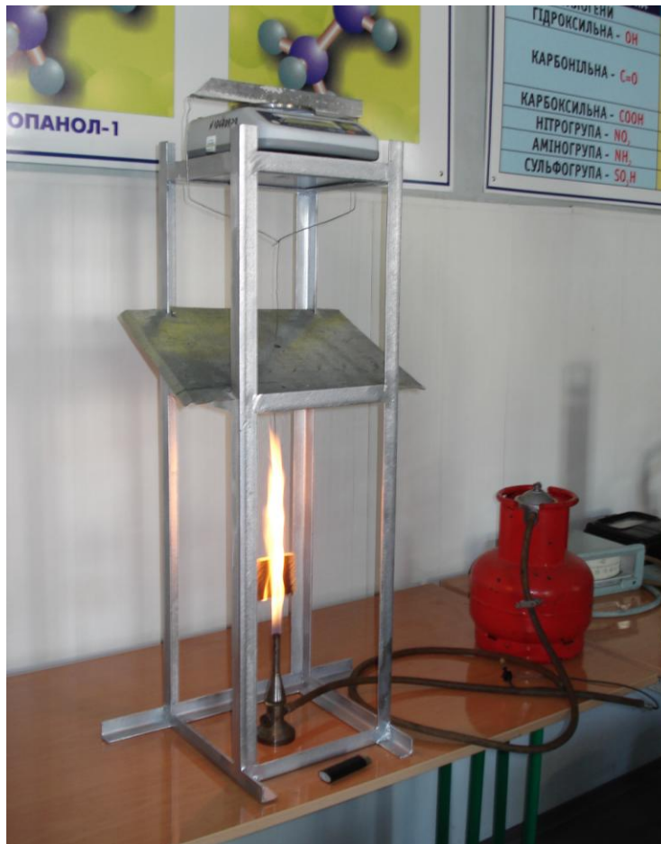
Рисунок 2.20. Внешний вид лабораторной установки для термических исследований
