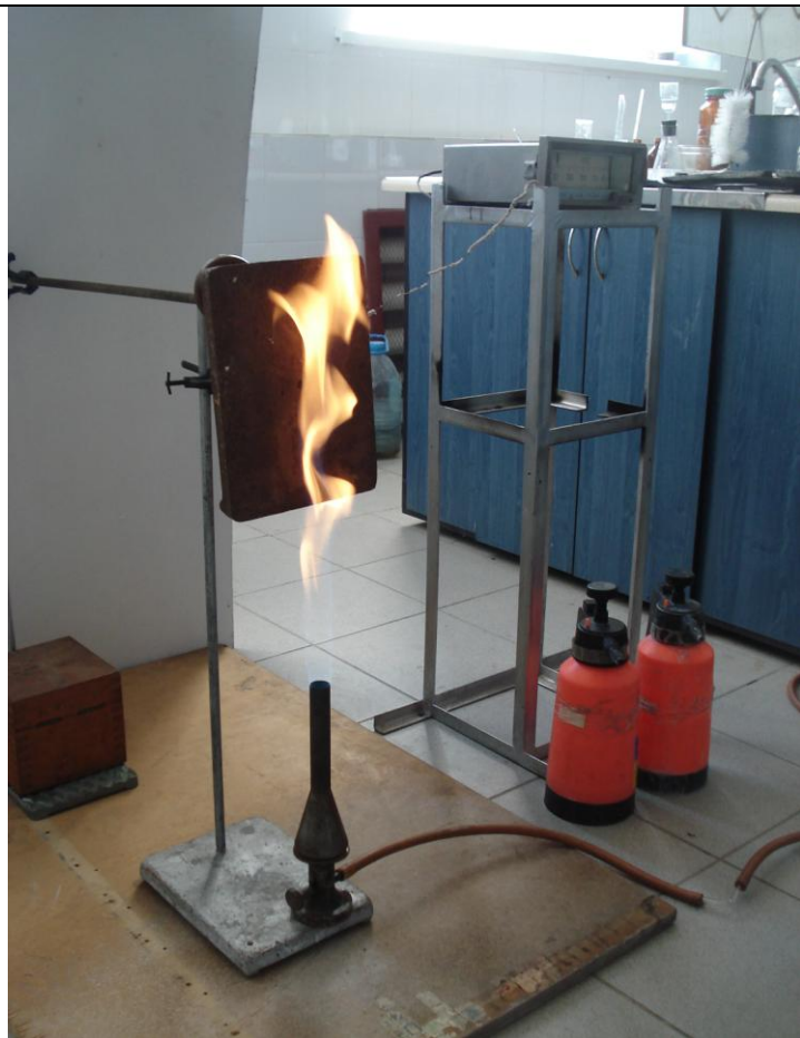
Рисунок 2.16. Установка для определения охлаждающего действия ГОС а – разогрев металлической пластины, б – подача на нагретую пластину распыленной воды;
