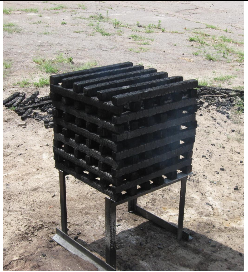
Рисунок 5.3. в – тушение стандартного модельного очага 1А, б – потушенный модельный очаг.
