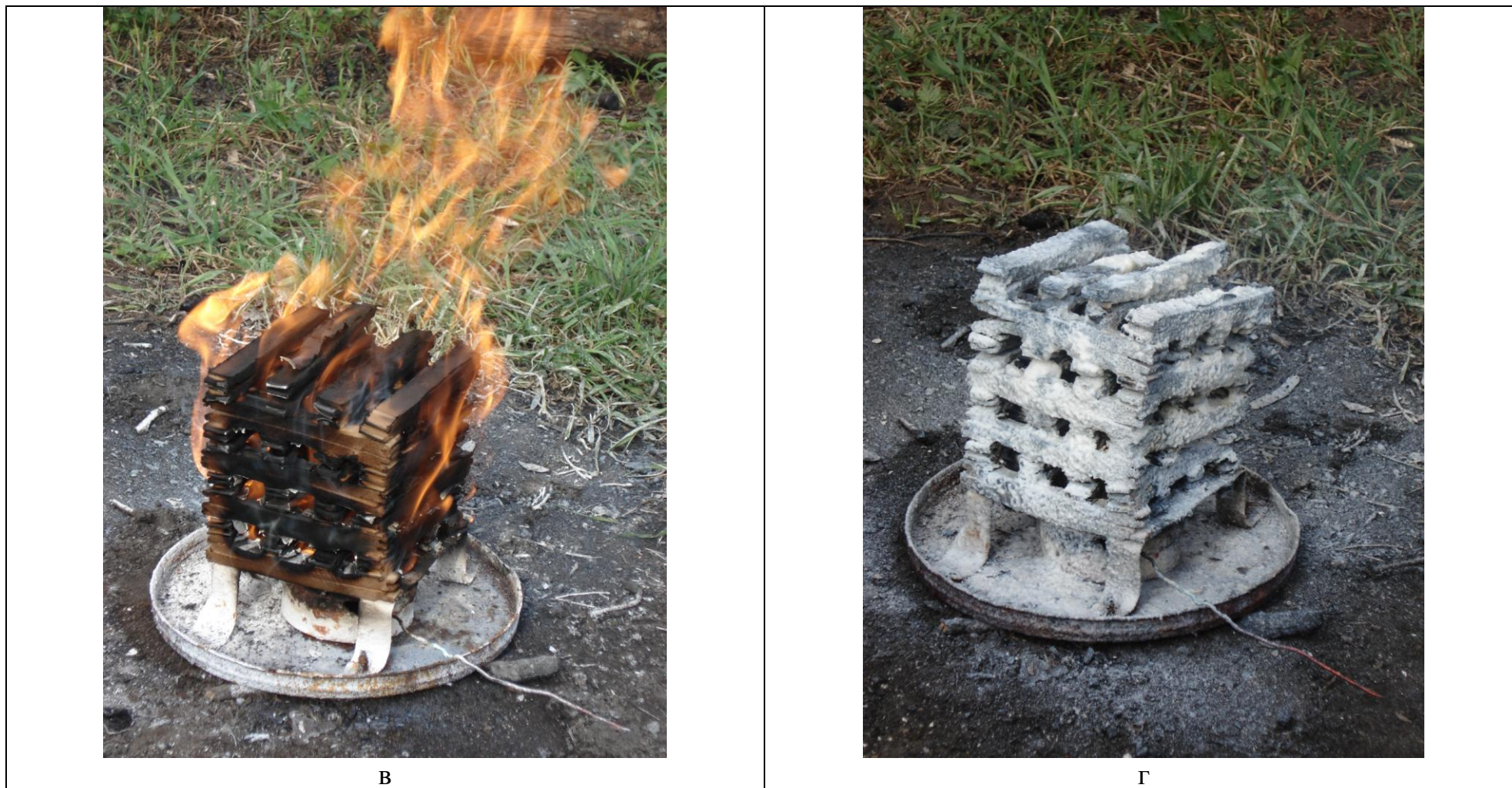
Рисунок 3.10. в – горение модельного очага из ДВП; г – модельный очаг из ДСП, потушенный ГОС \text{CaCl}_2 + \text{Na}_2\text{O} \cdot 2,7 \text{SiO}_2 .
