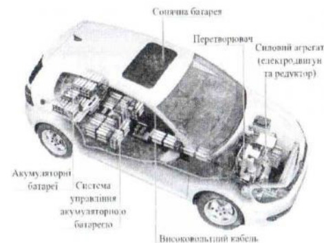
Рисунок 2 – Схема влаштування електромобіля
