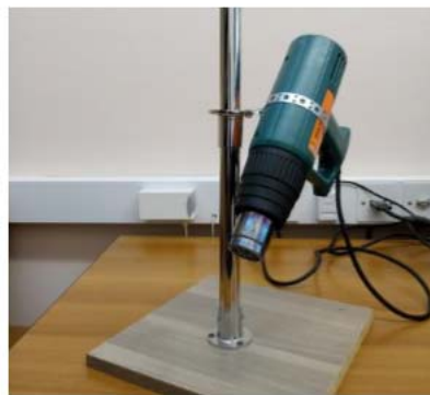
Рисунок 4 - Лабораторная установка: 1 – технический фен; 2 – стойка; 3 – подставка; \alpha – угол подачи теплового потока на образец
