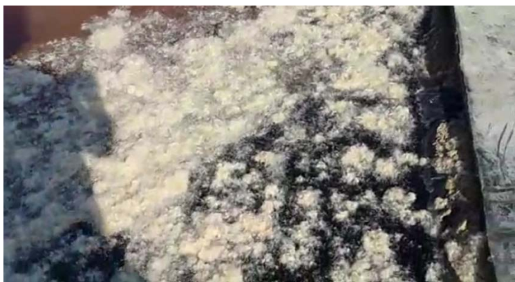
Рисунок 2 – Сорбент на основе ВОПР нанесенный на слой нефти на воде
