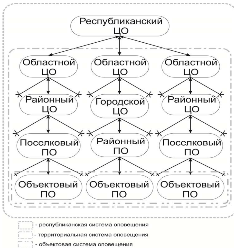
Рисунок 1 - Иерархический радиально-узловой принцип построения территориальной системы оповещения
