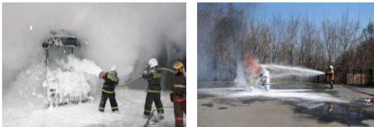
Рисунок 2 – Использование для тушения горящего автомобиля а) пеногенератора ГПС-600; б) компрессионной пены
