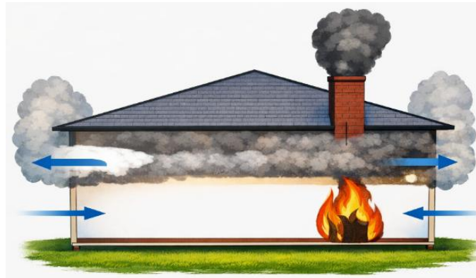
Рисунок 6.1 – Схема природного вентиляювання продуктів згоряння в одноповерховій будівлі
