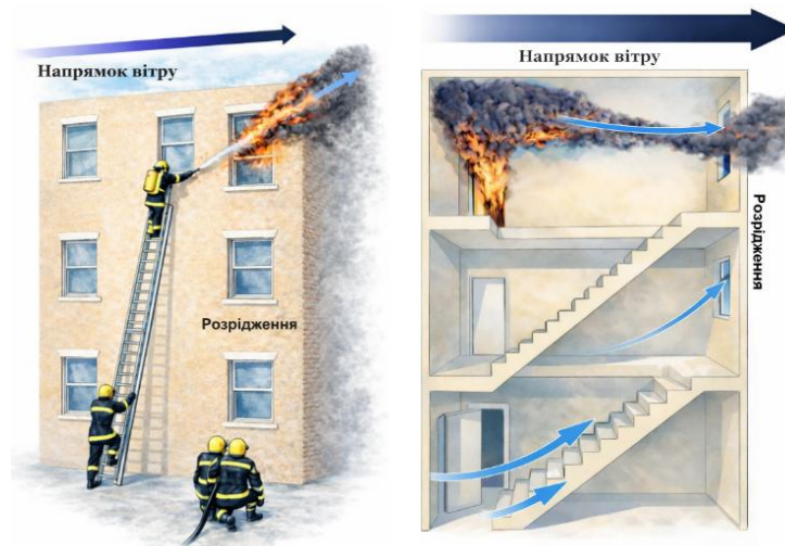
Рисунок 6.3 – Схема природного вентиляювання продуктів згоряння у будівлі
